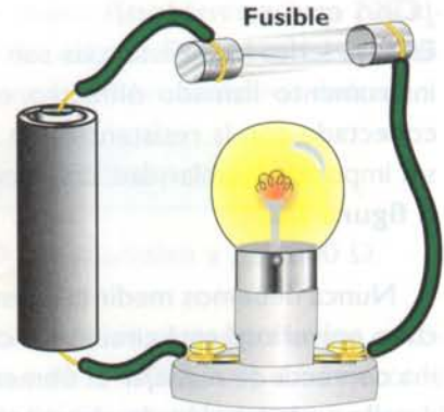
Figura 2.14. Protección contra cortocircuito
